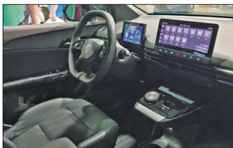
MG4 Electric - standard interiør. Legg merke til fysiske brytere til de viktigste funksjoner
