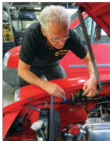
Jan Klemmetsby i Bil-Elektro i Tønsberg monterte releer og sikring mellom hovedlys og bryter.
