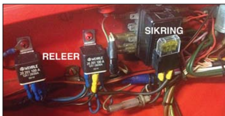
Jan Klemmetsby i Bil-Elektro i Tønsberg monterte releer og sikring mellom hovedlys og bryter.
