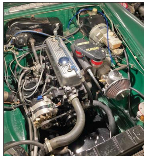
Ettermontering av komplett Janspeed turbo sett, samt ny overdrive girkasse med ny eksos på MGB 1977 modell.
