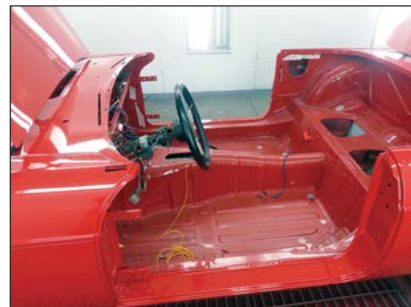
Bilen ble lakkert i to runder - først innvendig og etter at nyoverhalt motor og girkasse var montert ble bilen lakkert utvendig.
