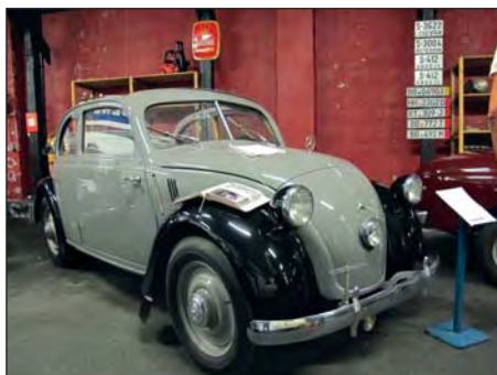
MB 170 H firesylindret 1697 cc motor med en effekt på 38 HK (28 kW) der "H" sto for "Heckmotor", http://www.bjarnelerumbil.no
