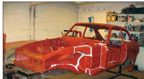
68 MGB GT Mk 2 etter grunning og fuging.
