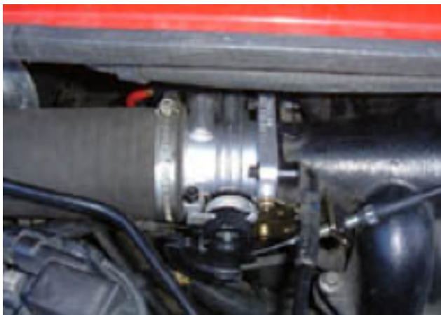
Gasspjeldhuset er plassert mellom luftfilteret og innsuget
